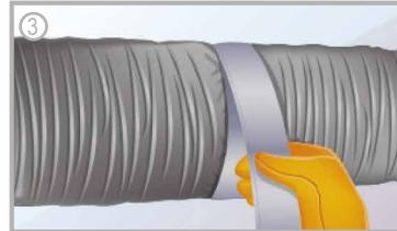
3.- Vuelva a colocar el aislamiento y la cubierta metálica. Envuelva las cubiertas juntas, con al menos dos vueltas de cinta para ducto.
