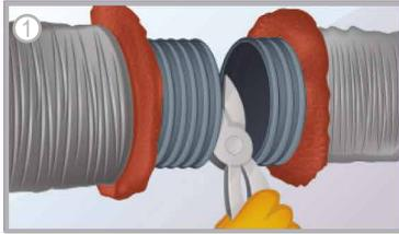
1.- Determine la longitud deseada. Corte completamente alrededor y a través del ducto con tijera o navaja. Corte el alambre con pinzas o tijeras de alambre.
