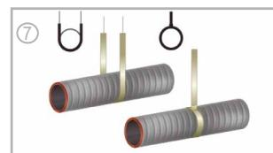
7.- El material que soporta al tubo no debe ser menos a 1.5 pulg. (38 mm) de ancho y no debe afectar el diámetro del ducto.
