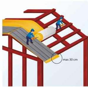
2- Desenrollar. Esta operación debe realizarse dando una ligera tensión al material (no excesiva, para evitar que la película se rasgue o deforme), con el objeto de que la superficie quede prácticamente plana.
