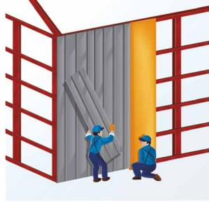
4- Colocar la lámina sobre el MBI y fijarla a la estructura.
